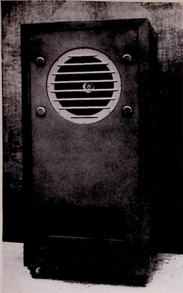
Fig. 8. — « AULOS »-luidspreker van 380 mm opgesteld in een « bass reflector ».
